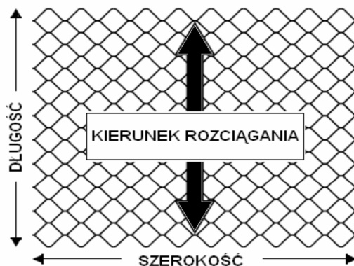
Rysunek 2 - Sekcja geosiatki komórkowej (geomaty) - określanie kształtu i wymiarów.
