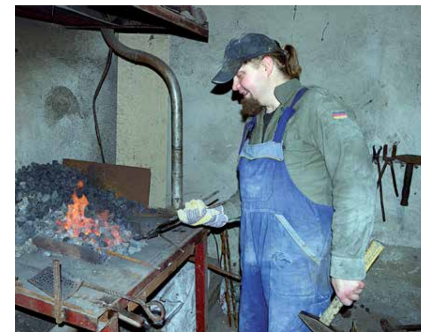
Aby metal można było łatwiej obrócić należy go podgrzać do temperatury nawet 900 °C
