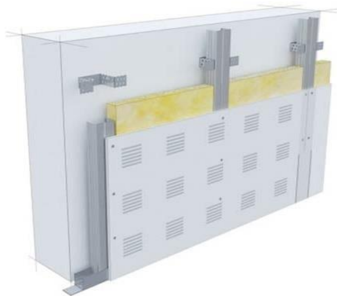
Rys. 11: Okładzina dźwiękochłonna kotwiona, wg schematu Nida Tynk CD/ES-12,5. Pokryciem jest jedna warstwa płyty perforowanej, która przepuszcza dźwięk.
