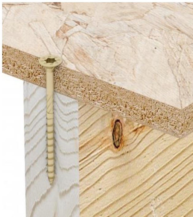
Rys. 21: Połączenie typu T, na przykładzie mocowania półki, wkręt przechodzi na wylot przez belkę (płytę) pod kątem 90°
