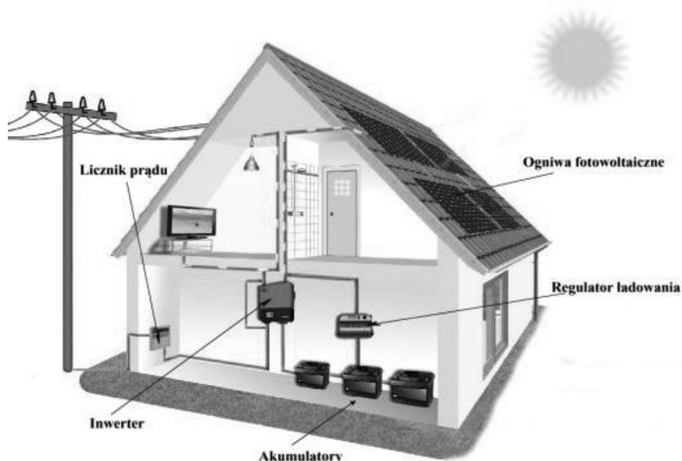
Ryc. 12. Schemat instalacji fotowoltaicznej w domu jednorodzinnym
