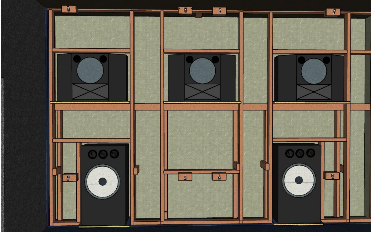
Stelaż – konstrukcja ściany akustycznej.
