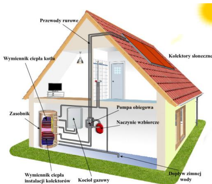
Ryc. 11. Schemat instalacji kolektorów słonecznych w domu jednorodzinnym
