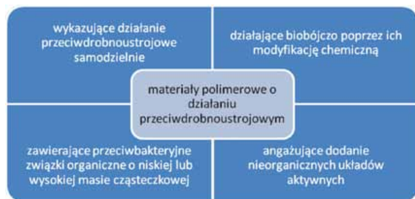
■ Rys. 1. Rodzaje materiałów polimerowych o działaniu przeciwdrobnoustrojowym. Źródło: opracowanie własne na podstawie 3
